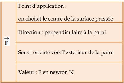
Exemple : Force pressante exercée par le fluide sur la membrane élastique :
