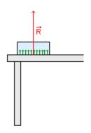
Rest la réaction de la table sur le livre. C'est une force répartie sur toute la surface de contact.
